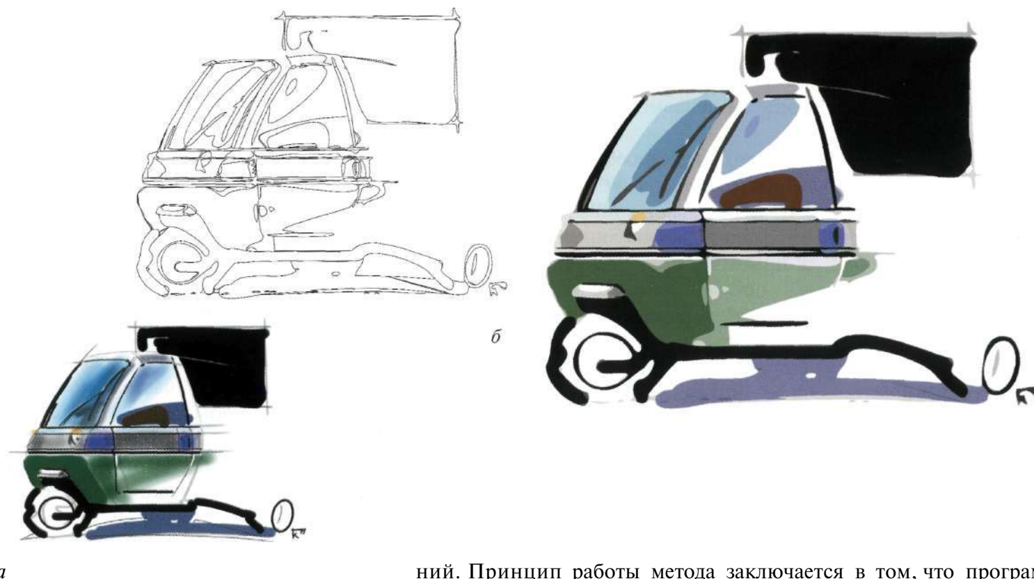
Рис. 12.12. Пример трассировки методом «по очертанию»: а - исходное растровое изображение; б - результат трассировки
