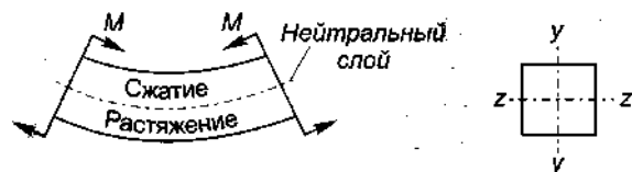
Рис. 5.35. Схема деформации при чистом изгибе
