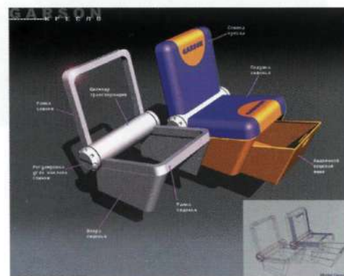
Рис. 12.35. Проект универсального транспортного средства: а - эскиз (Studio Paint); б - 3D модель; в - трехосная модификация; г - взрыв-схема; д - ситуация (3D модель и эргоном); е - сиденья; ж - руль с интегрированной панелью приборов
