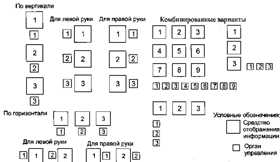
Рис. 7.7. Рекомендуемые варианты размещения органов управления и средств отображения информации
